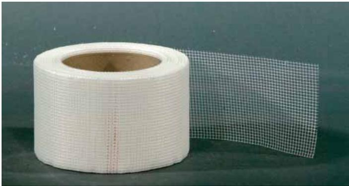
Le canevas AB-151 est un produit multi-usage pour les systèmes de gaines en fibre de verre. Il est principalement utilisé pour une fixation provisoire du système de gaines avant l'application du produit d'étanchéité. À utiliser avec les applications certifiées UL 181A-M.
